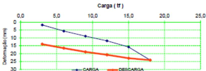
Figura 14 - Gráfico do ensaio de arrancamento de um dos grampos.
