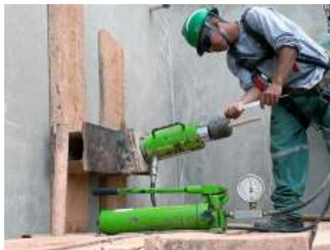
Figura 13: Ensaio de arrancamento
